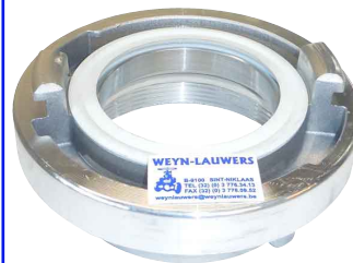
STORZ F-schroefdraad 1" tot 6" nok : 44 - 52 - 66 - 81 - 105 - 115 - 133 - 160 werkdruk max. 16 bar aluminium met NBR dichting
