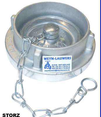
STORZ stop met ketting nok : 44 - 52 - 66 - 81 - 105 - 115 - 133 - 160 werkdruk max. 16 bar aluminium met NBR dichting
