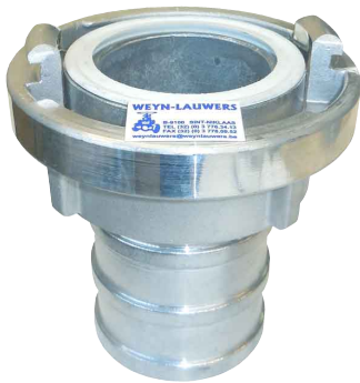
GUILLEMIN slangtule met grendel diam. 20 mm tot diam. 152 mm werkdruk max. 16 bar aluminium met witte NBR dichting RVS 316 met viton dichting
